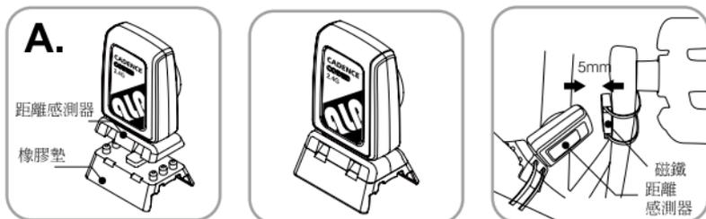
1. 將腳踏圈速感測器 Logo 朝外與橡膠座用束帶共同安置於下管上。
